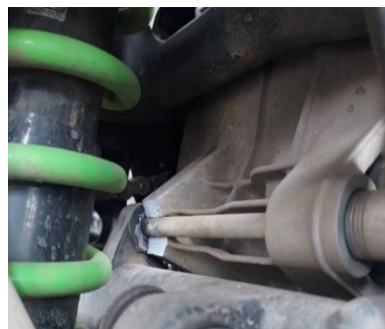
แตรเครื่องยนต์แตกร้าวจากโครงรถที่เกิดความเสียหาย
