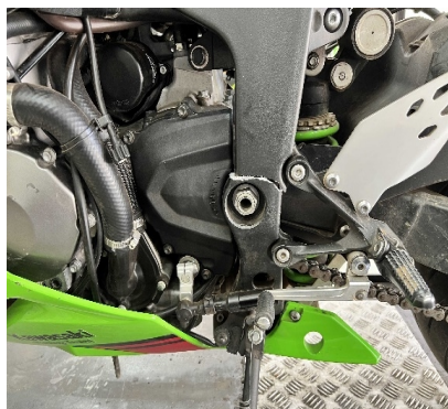
โครงรถแตกร้าวจากแรงสั่นสะเทือน
