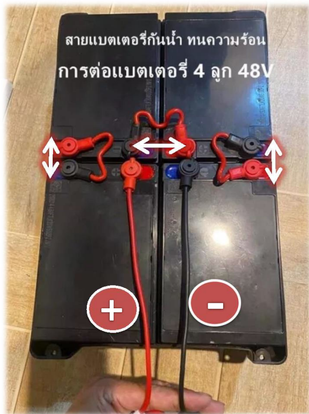
(1) การต่อ แบตเตอรี่ 12V 12A จำนวน 4 ลูก (รูปแบบทั่วไปสำหรับจักรยานไฟฟ้า)
